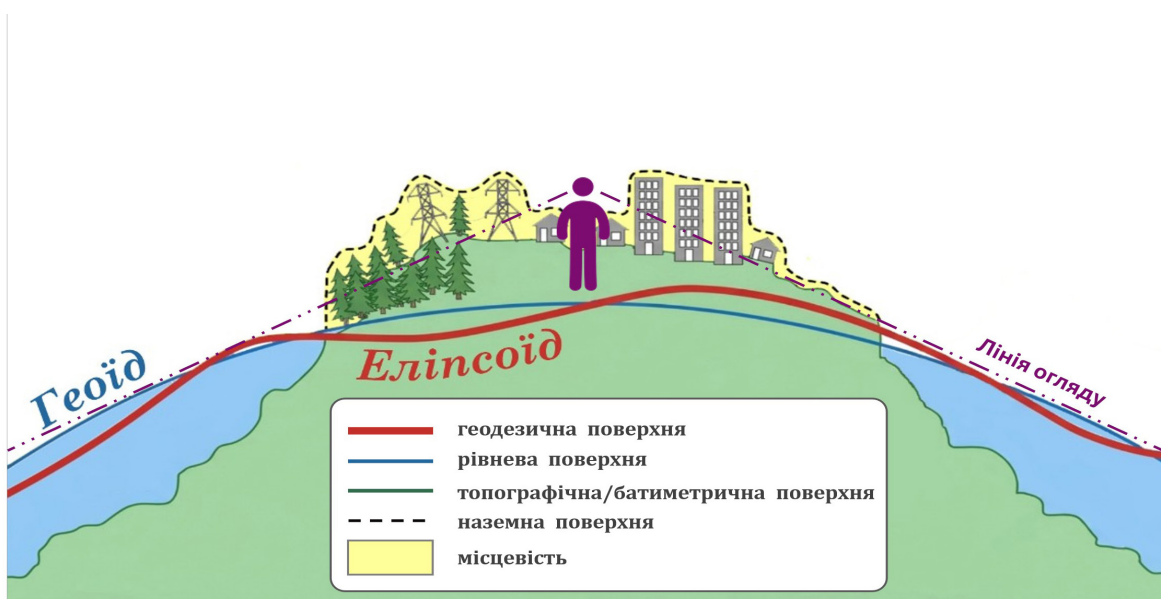
Рис. 1. Вертикальна структура місцевості як композиту поверхонь. Fig. 1. Vertical structure of the terrain as a composite of surfaces.
